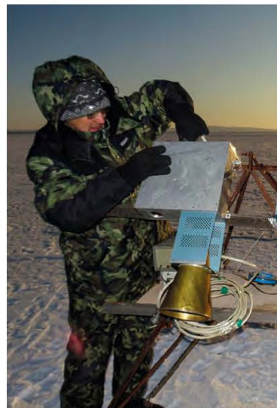
С.н.с., к.ф.-м.н. А. А. Гурулев и н.с., к.ф.-м.н. А. О. Орлов изучают ледяной покров оз. Арахлей на частотах 13,4 ГГц и 10 ГГц
