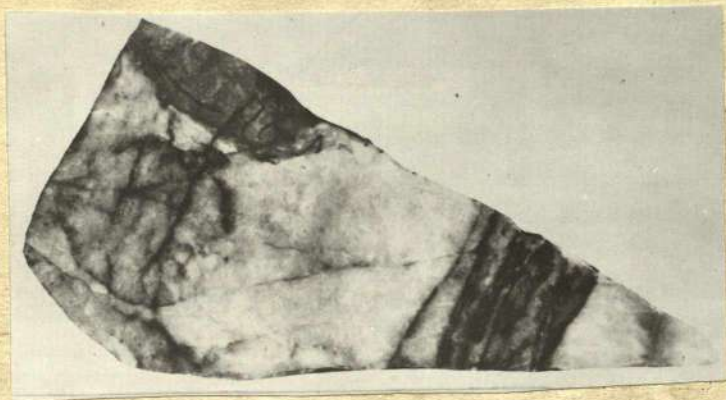
Рис. 3. Неясно-полосчатая текстура продуктивного минерального комплекса. Видны пластины углистого сланца, вдоль контакта с ними развиты сульфиды, выделяющиеся и вокруг переработанных обломков вмещающих песчаников. Уменьшено в 2 раза, Николаевское месторождение, обр. 38/80 Б.
