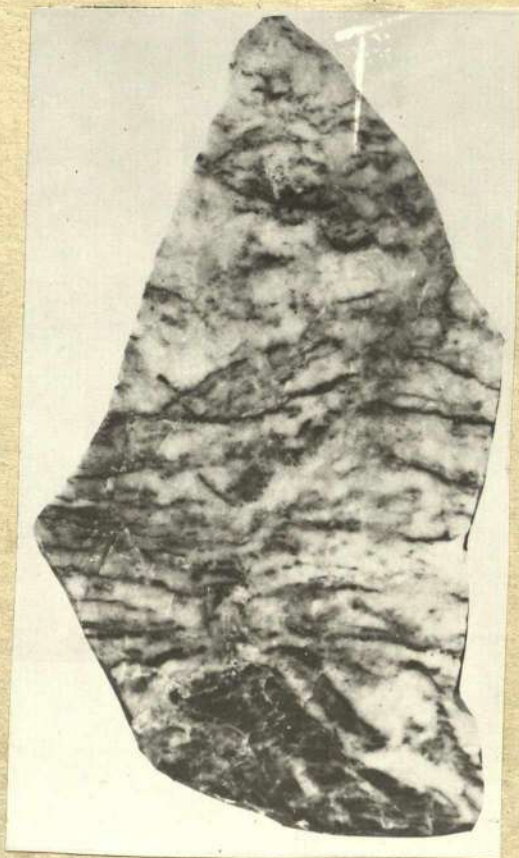
Рис. 2. Жильный кварц полосчатой текстуры с изогнутыми обломками сланца. Обр. 18/80, месторождение Никольское (Центральное Забайкалье), отвал штольни 20. Натуральная величина
