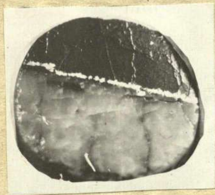
Рис. 4. Арсенопирит на контакте кварца и тонкозернистого песчаника. Видны тонкие ответвления нитевидных прожилков. Любавинское месторождение, обр. 52/81. Увел. 1,5 раза.
