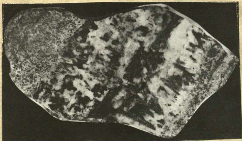
Рис. 8. Фрагмент строения полосчатой сульфосольно-халькопиритово-пиритово-арсенопиритово-кварцевой жилы Широкой, Верхне-Алиинское месторождение
