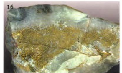
16. Прерывистый слой низкопробного золота в халцедоновидном кварце. 5.5 x 3.6 см. Рудная зона 1, гор. 216 м. Вверху видны фрагменты фестонов с Ag-содержащей блеклой рудой.
