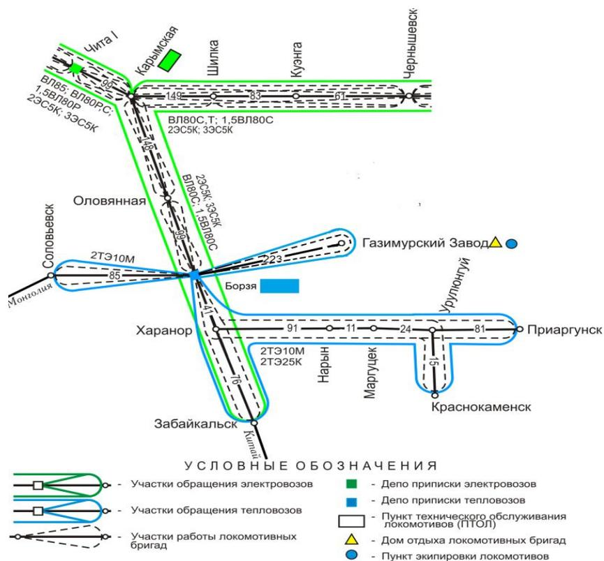
Рисунок 1. Схема тягового обслуживания и работы локомотивных бригад.
